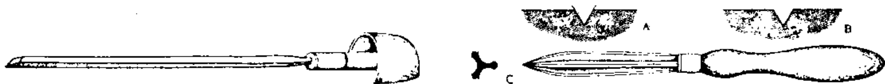
طرحی از یک قلم حکاکی و نمونه‌ای از یک نوع Scraper و مقطع آن
