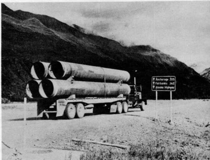
حمل لوله‌های ۴۸ اینچی به یکی از نواحی ساختمان خط لوله نفت آلاسکا.
